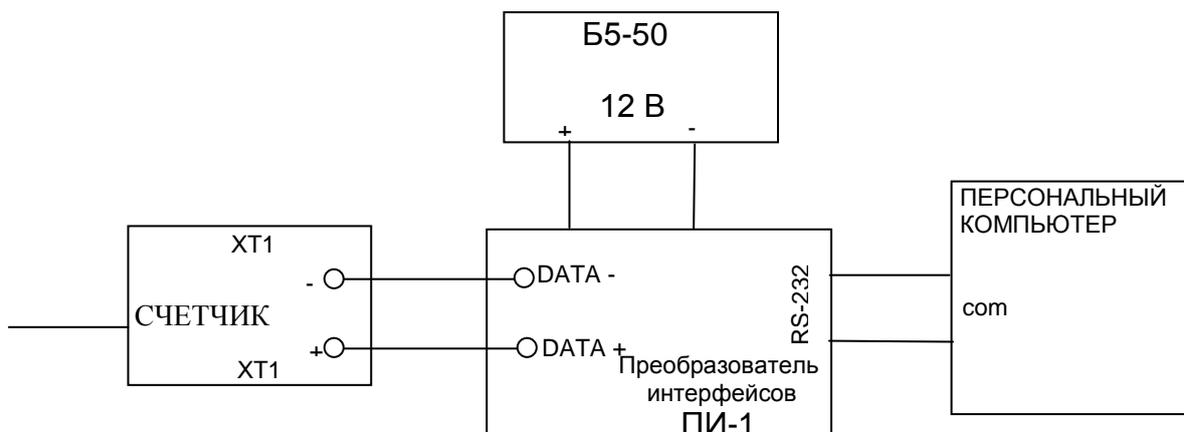
Рисунок Б.3 – Блок-схема подключения счетчика с RS-485 к IBM PC
