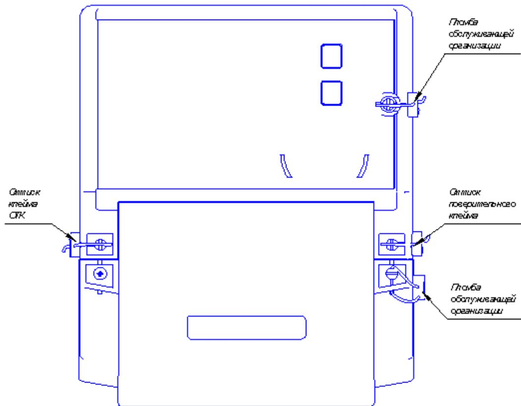
Рисунок 1 – Пломбирование счётчика
